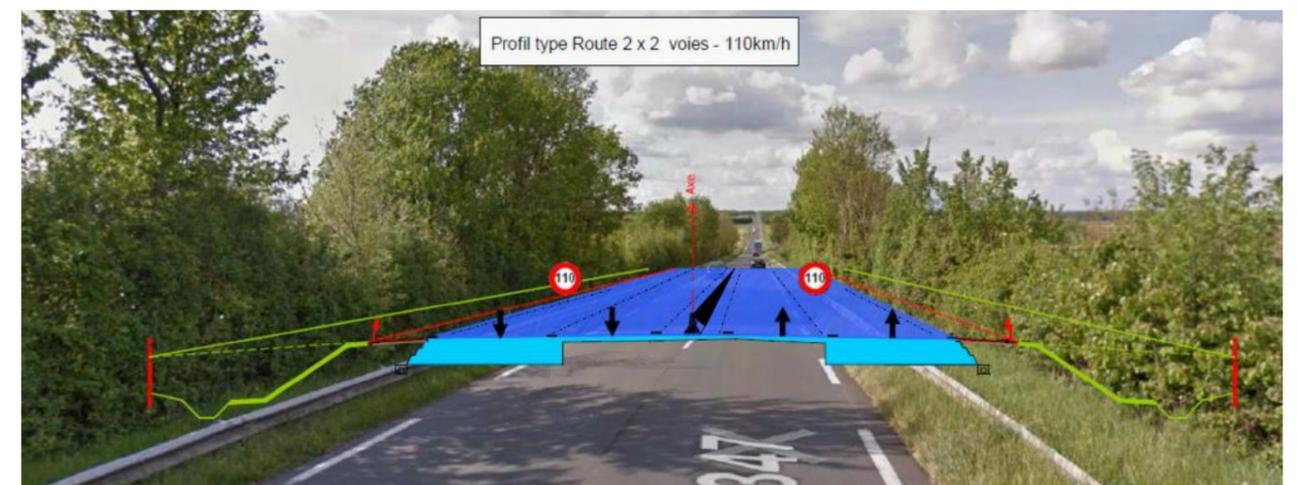
Figure 9 : Profil en travers de la section en déblai (N°38)
