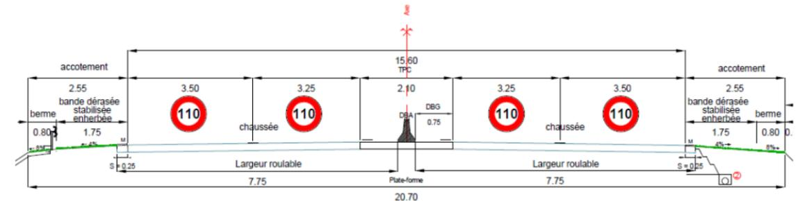
Figure 8 : Principe d'élargissement à 2x2 voies
